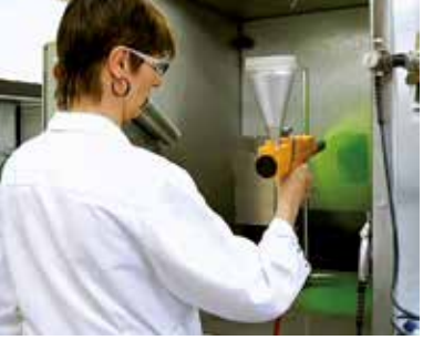
Beschichten der Probebleche in Ganzlin
