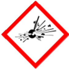
GHS01 - Unstabil, Explosionsgefahr
